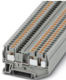
Durchgangsklemme, Anschlussart: Push-in-Anschluss, Querschnitt: 0,2 mm 2 - 6 mm 2 , AWG: 24 - 10, Breite: 6,2 mm, Farbe: grau, Montageart: NS 35/7,5, NS 35/15
