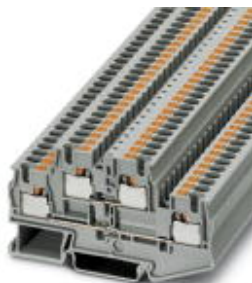
Doppelstock-Klemme, Querschnitt: 0,2 mm 2 - 6 mm 2 , AWG: 24 - 10, Anschlussart: Push-in-Anschluss, Breite: 6,2 mm, Farbe: grau, Montageart: NS 35/7,5, NS 35/15
