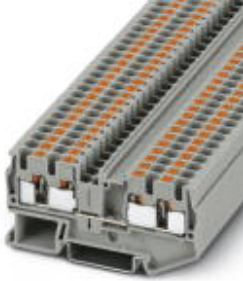
Durchgangsklemme, Anschlussart: Push-in-Anschluss, Querschnitt: 0,2 mm 2 - 6 mm 2 , AWG: 24 - 10, Breite: 6,2 mm, Höhe: 35,3 mm, Farbe: grau, Montageart: NS 35/7,5, NS 35/15
