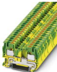
Schutzleiter-Reihenklemme, Anschlussart: Push-in-Anschluss, Querschnitt: 0,2 mm 2 - 6 mm 2 , AWG: 24 - 10, Breite: 6,2 mm, Höhe: 35,3 mm, Farbe: grün-gelb, Montageart: NS 35/7,5, NS 35/15
