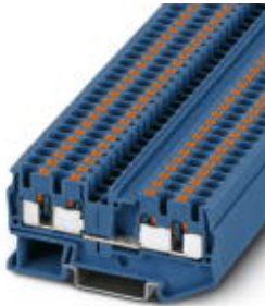
Durchgangsklemme, Anschlussart: Push-in-Anschluss, Querschnitt: 0,2 mm 2 - 6 mm 2 , AWG: 24 - 10, Breite: 6,2 mm, Höhe: 35,3 mm, Farbe: blau, Montageart: NS 35/7,5, NS 35/15
