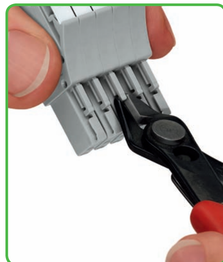
Federleiste kodieren – gewünschte Kodiernase mittels geeignetem Werkzeug von Federleiste abtrennen . . .
