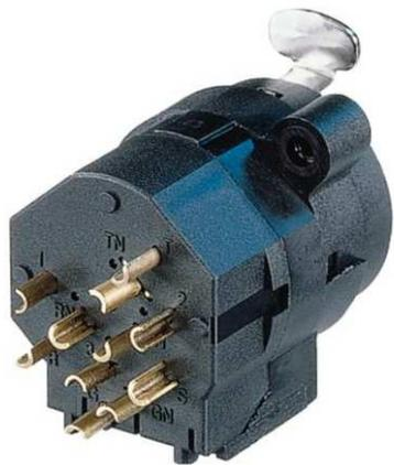
3 polige XLR Einbaubuchse kombiniert mit 6.35 mm Klinkenstecker, stereo, ohne 'Normaling' Kontakt, Lötanschlüsse.
