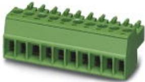
Steckerteil, Nennstrom: 8 A, Bemessungsspannung (III/2): 160 V, Polzahl: 10, Rastermaß: 3,5 mm, Anschlussart: Schraubanschluss, Farbe: grün, Kontaktoberfläche: Zinn
