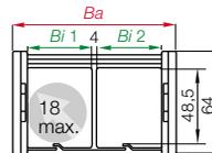
**Serie Z300 - im Innenradius zu befüllen mit 3-Kammersystem**
