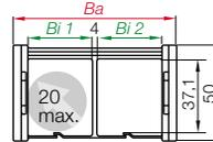
**Serie Z26 - im Innenradius zu befüllen - mit 3-Kammersystem**
