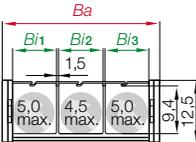
Serie E045 - im Außenradius zu befüllen mit 3-Kammersystem
