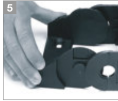
5 Anschlusselement einsetzen und klicken
