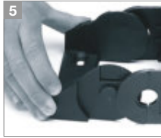
5 Anschlusselement einsetzen und klicken
