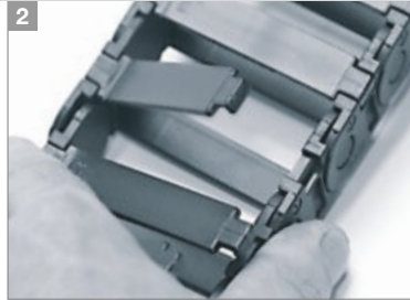
...anschließend Bolzen einklicken
