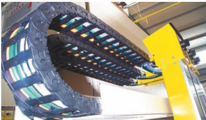
3 Konfektionierte System E2/000 E-Ketten* nebeneinander eingebaut
