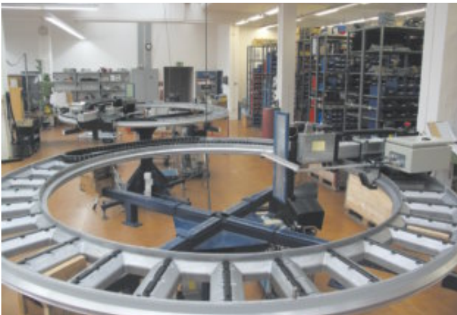
E2 mini E-Kette® als RBR-Version mit beidseitigem Biegeradius
