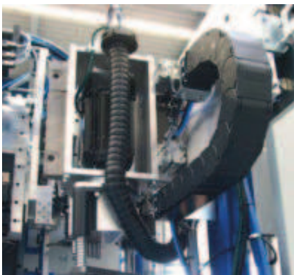
igus® E2 E-Rohr und Triflex® R in einem Bearbeitungszentrum
