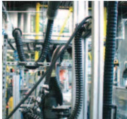
Torsionsprüfungen der Triflex® R im igus® Labor, Köln
