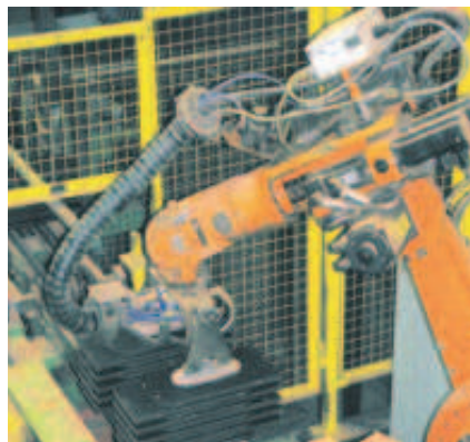
Optimale Leitungsführung auch unter extremen Bedingungen, wie hier im Dachziegelwerk Jungmeier
