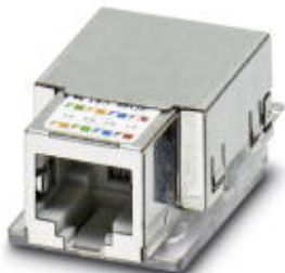
RJ45-Buchseneinsatz, für Freenet-System, CAT5e, 8-polig, geschirmt, mit Kabelanschluss (IDC-Schnellanschluss), für starre Adern AWG 24 ... 22
