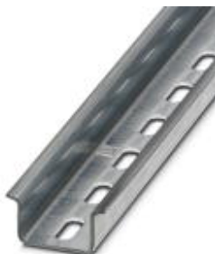
Tragschiene, Material: verzinkt, gelocht, Höhe 15 mm, Breite 35 mm, Länge: 2 m
