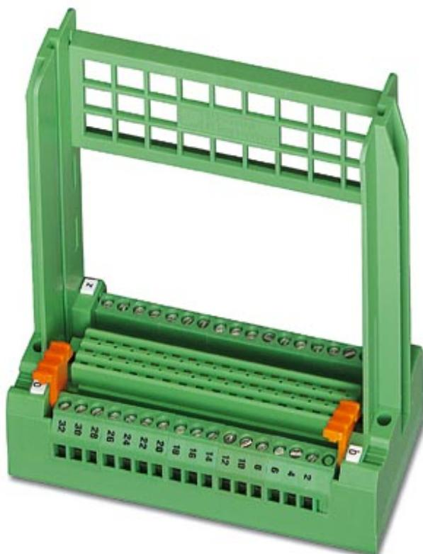
Steckkartenblock, für indirekte Steckung gemäß IEC 603-1/DIN 41617, mit Führungsleisten, Verriegelungsklinken ohne Auswerfhilfe, mit normgerechter Beschriftung auf beiden Anschlussseiten, sowie Befestigungsschrauben M4, Bestückung in der Reihe Z und B
