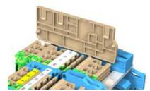
Halteplatten, die in der P-Reihe auch die Funktion der Abschlussplatten übernehmen, müssen beim Einsatz der 10 x 3 Sammelschiene alle 200 mm gesetzt werden.
