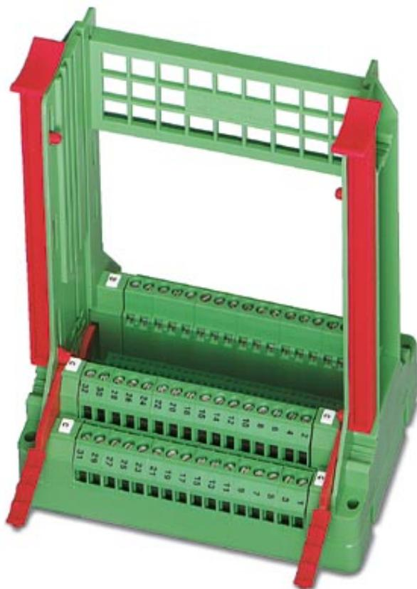
Steckkartenblock, für indirekte Steckung gemäß IEC 603/DIN 41612, komplett mit Führungsleisten, Verriegelungsklinken und Ausstoßhilfe, mit normgerechter Beschriftung auf beiden Anschlussseiten, sowie Befestigungsschrauben M 4, Querschnitt 0,2 - 4 mm<sup>2</sup> starr/ 0,2 - 2,5 mm<sup>2</sup> flexibel, 1 A, 125 V, Polzahl 64
