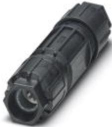
QUICKON Leitungsverbinder, schwarz, 3+PE-polig, 1,0 mm<sup>2</sup> ... 2,5 mm<sup>2</sup> / 630 V / 20 A, für Kabeldurchmesser 9 mm ... 14mm.
