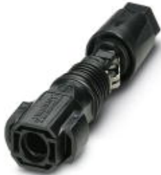
Photovoltaik-Steckverbinder, Nennstrom: 40 A, Nennspannung: 1100 V, Anschlussart: Federkraft, Farbe: schwarz, Nur mit Werkzeug entriegelbar
