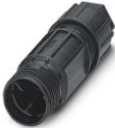
QUICKON Leitungsverbinder, schwarz, 3+PE-polig, 1,0 mm 2 ... 2,5 mm 2 / 630 V / 20 A, für Kabeldurchmesser 9 mm ... 14mm.
