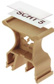
Der Gruppenschildträger **SchT 5 S** wird direkt auf die Tragschiene TS 32 (G-Schiene) bzw. die Tragschiene TS 35 (Hutschiene) aufgerastet. Unabhängig von Klemme und Klemmentyp kann so die Klemmleistenkennzeichnung vorgenommen werden. **SchT 5** und **SchT 5 S** werden mit ESO 5, STR 5 Schutzstreifen bestückt. Einsteckschilder und Schutzstreifen befinden sich unter Zubehör.
