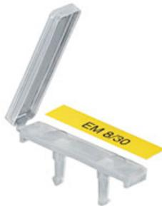
Der Endwinkelmarkierer **EM 8/30** ist geeignet für die Kennzeichnung der Endwinkel WEW 35/2 und ZEW 35/2, wie auch als Gruppenschildträger für Klemmen der W-Reihe. Der **EM 8/30** kann mit Einlegeschildern ESO 7/ESO 7P bestückt werden. Die Tasche gewährleistet einen hohen Schutz der Beschriftung vor Umgebungseinflüssen. Einsteckschilder befinden sich unter Zubehör.
