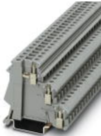
Initiatoren-/Aktorenklemme, Querschnitt: 0,2 mm 2 - 4 mm 2 , AWG: 24 - 12, Anschlussart: Schraubanschluss, Breite: 6,2 mm, Farbe: grau, Montageart: NS 35/7,5, NS 35/15
