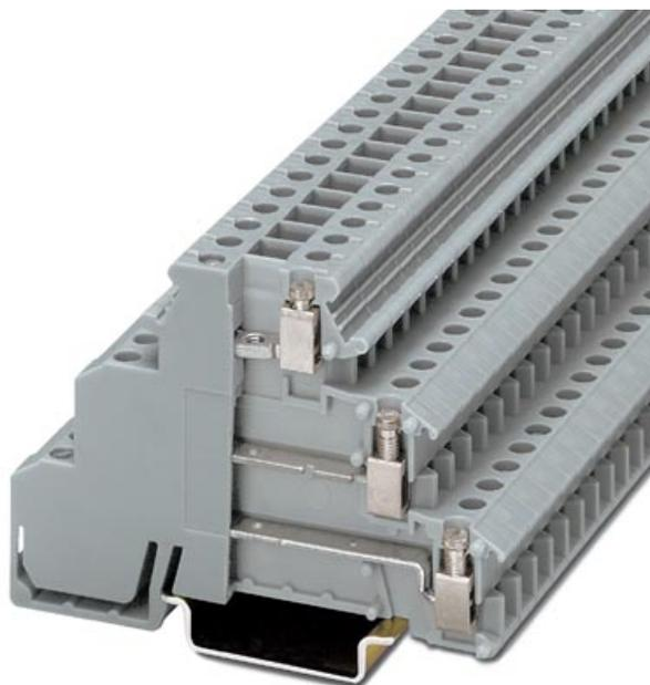
Dreistock-Initiatoren-Klemme, Querschnitt: 0,2-2,5 mm<sup>2</sup>, AWG: 30-14, Breite: 6,2 mm, Farbe: grau
