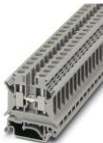
Durchgangsklemme, Anschlussart: Schraubanschluss, Querschnitt: 0,2 mm 2 - 10 mm 2 , AWG: 24 - 8, Breite: 8,2 mm, Farbe: grau, Montageart: NS 35/7,5, NS 35/15, NS 32
