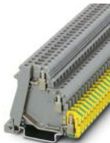
Initiatoren-/Aktorenklemme, Querschnitt: 0,2 mm 2 - 4 mm 2 , AWG: 24 - 12, Anschlussart: Schraubanschluss, Breite: 6,2 mm, Farbe: grau, Montageart: NS 35/7,5, NS 35/15
