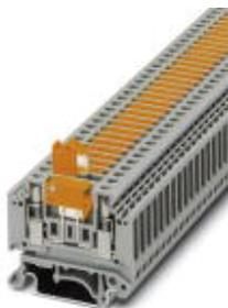
Messer-Trennklemme, Anschlussart: Schraubanschluss mit Prüfbuchschrauben, Querschnitt: 0,2 mm<sup>2</sup> - 4 mm<sup>2</sup>, AWG: 24 - 12, Nennstrom: 16 A, Nennspannung: 400 V, Länge: 46 mm, Breite: 5,2 mm, Farbe: grau, Montage: NS 35/7,5, NS 35/15, NS 32
