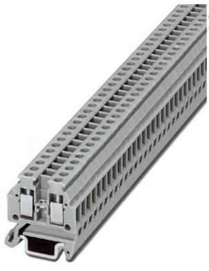
Reihenklemme mit Schraub-Anschluss, Querschnitt: 0,14-1,5 mm², AWG: 30-14, Breite: 4,2 mm, Farbe: grau
