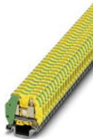
Schutzleiter-Reihenklemme, Anschlussart: Schraubanschluss, Querschnitt: 0,14 mm 2 - 1,5 mm 2 , AWG: 26 - 16, Breite: 4,2 mm, Farbe: grün-gelb, Montageart: NS 15
