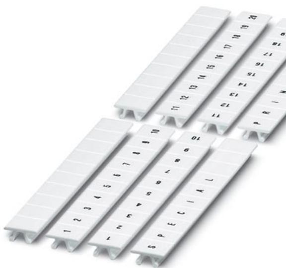
Zackband, 10-teilig, unbedruckt, zum Selbstbeschriften mit B-STIFT, ZB-T oder CMS-System, ausreichend für 100 Klemmen, für eine Klemmenbreite von 8,2 mm, Farbe: weiß
