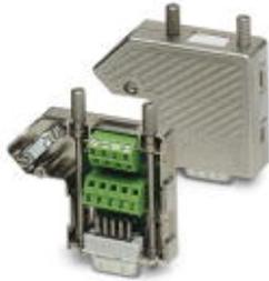
D-SUB-Stecker, 15-polige Buchse, eine Kabelzuführung unter 35°, Universaltyp für alle Systeme, Pinbelegung: 1,2,3,...,14,15 auf Schraubanschlussklemme
