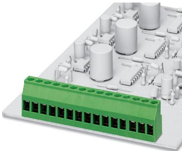
Printklemme, Nennstrom: 24 A, Bemessungsspannung: 250 V, Raster: 5,0 mm, Polzahl: 2, Montageart: Löten, Anschlussart: Schraubanschluss, Anschlussrichtung vom Leiter zur Platine: 0°
