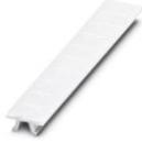
Abbildung zeigt Variante ZB 6:UNBEDRUCKT Zackband, Streifen, weiß, beschriftet, beschriftbar mit: Plotter, längs: L1, L2, L3, N, PE, L1, L2, L3, N, PE, Montageart: Verrasten in hoher Schildchennut, für Klemmenbreite: 6,2 mm, Schriftfeldgröße: 6,15 x 10,5 mm
