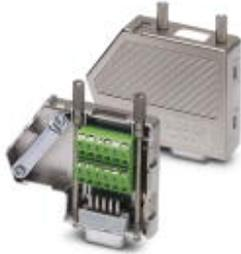
D-SUB-Stecker, 9-polige Buchse, zwei Kabelzuführungen unter 35°, Bussystem: MODBUS, BODBUS-PLUS, BITBUS, ARCNET, MULT/MININET(B&R), SYSTEM 2003(B&R), P-NET, Pinbelegung: 1, 2, 3, 5, 6, 8; Schraubanschlussklemmen
