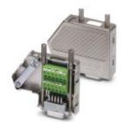
D-SUB-Stecker, 9-polig, Stift, zwei Kabelzuführungen unter 35°, Bussystem: CAN, SUCONET K1, K2 (MOELLER), S-BUS (Saia), J-BUS (Merlin Gerin), Pinbelegung: 2, 3, 4, 5, 7, 9 auf je zwei Schraubanschlussklemmen
