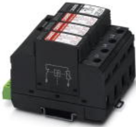
Überspannungsableiter bestehend aus Basiselement mit FM-Kontakt und Schutzsteckern, zur Montage auf NS 35/7,5, Nennspannung: 230 V AC, 3 + 1-Schaltung
