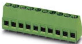
Leiterplattenklemme, Nennstrom: 17,5 A, Nennspannung: 400 V, Rastermaß: 5,08 mm, Polzahl: 8, Anschlussart: Schraubanschluss, Montage: Löten, Anschlussrichtung Leiter/Platine: 0 °, Farbe: grün, Der Artikel ist zu unterschiedlichen Polzahlen anreihbar!
