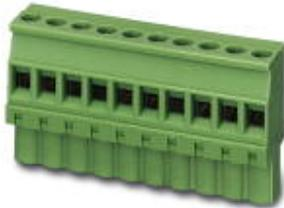
Steckerteil, Nennstrom: 12 A, Bemessungsspannung (III/2): 320 V, Polzahl: 8, Rastermaß: 5 mm, Anschlussart: Schraubanschluss, Farbe: grün, Kontaktfläche: Zinn
