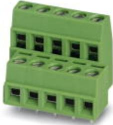
Leiterplattenklemme, Nennstrom: 13,5 A, Nennspannung: 400 V, Rastermaß: 5,08 mm, Polzahl: 7, Anschlussart: Schraubanschluss, Montage: Löten, Anschlussrichtung Leiter/Platine: 0 °, Farbe: grün, Der Artikel ist zu unterschiedlichen Polzahlen anreihbar!
