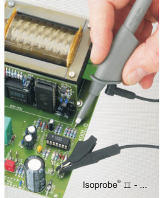
Passiver Tastkopf, hohe Eingangskapazität
