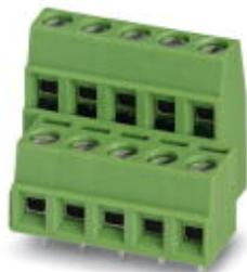
Leiterplattenklemme, Nennstrom: 13,5 A, Nennspannung: 400 V, Rastermaß: 5,08 mm, Polzahl: 2, Anschlussart: Schraubanschluss, Montage: Löten, Anschlussrichtung Leiter/Platine: 0 °, Farbe: grün, Der Artikel ist zu unterschiedlichen Polzahlen anreihbar!
