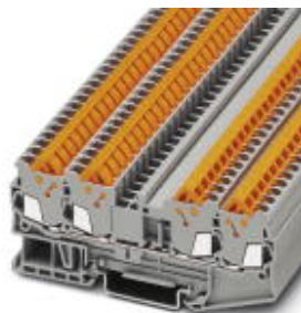
Durchgangsklemme, Anschlussart: Schnellanschluss, Querschnitt: 0,25 mm 2 - 1,5 mm 2 , AWG: 24 - 16, Breite: 5,2 mm, Farbe: grau, Montageart: NS 35/7,5, NS 35/7,5
