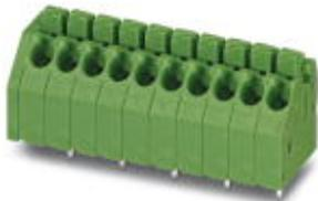
Leiterplattenklemme, Nennstrom: 2 A, Nennspannung: 400 V, Rastermaß: 3,5 mm, Polzahl: 5, Anschlussart: Federkraftanschluss, Montage: Löten, Anschlussrichtung Leiter/Platine: 45 °, Farbe: grün, Versetze Lötbeine, zweireihig
