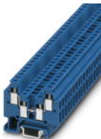
Durchgangsklemme, Querschnitt: 0,14 mm 2 - 1,5 mm 2 , AWG: 26 - 16, Anschlussart: Schraubanschluss, Breite: 4,2 mm, Farbe: blau, Montageart: NS 15
