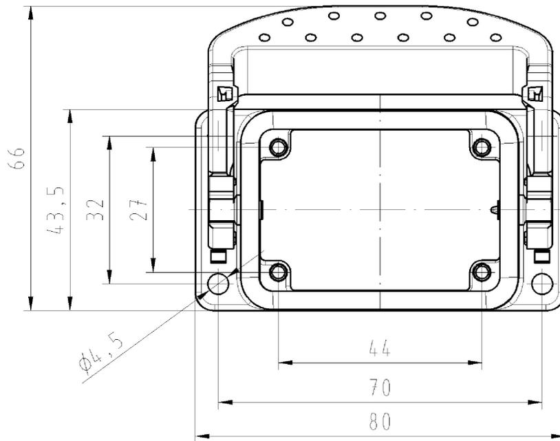
○ Diese Maße werden bei Abnahme besonders geprüft
