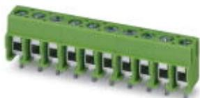
Leiterplattenklemme, Nennstrom: 17,5 A, Nennspannung: 400 V, Rastermaß: 5 mm, Polzahl: 9, Anschlussart: Schraubanschluss, Montage: Löten, Anschlussrichtung Leiter/Platine: 0 °, Farbe: grün, Auch möglich: Anschluss eines Leiters 1,5 mm<sup>2</sup> mit Aderendhülse, dann allerdings Verringerung der Bemessungsspannung bzw. Verschmutzungsgrad / Überspannungskategorie.
