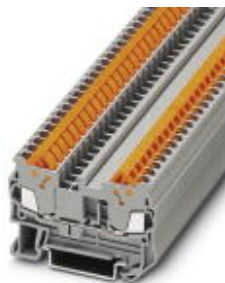
Schnellanschlussklemme, Anschlussart: Schnellanschluss, Querschnitt: 0,25 mm 2 - 1,5 mm 2 , AWG: 24 - 16, Breite: 5,2 mm, Farbe: grau, Montageart: NS 35/7,5, NS 35/15
