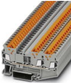
Durchgangsklemme, Anschlussart: Schnellanschluss, Querschnitt: 0,25 mm 2 - 1,5 mm 2 , AWG: 24 - 16, Breite: 5,2 mm, Farbe: grau, Montageart: NS 35/7,5, NS 35/7,5
