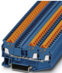
Durchgangsklemme, Anschlussart: Schnellanschluss, Querschnitt: 0,25 mm 2 - 1,5 mm 2 , AWG: 24 - 16, Breite: 5,2 mm, Farbe: blau, Montageart: NS 35/7,5, NS 35/7,5
